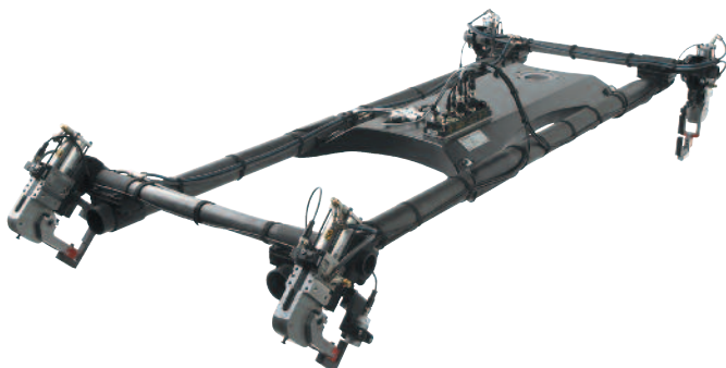
Stingray(Скат) в составе грейферной системы – общий вес около 30 кг
