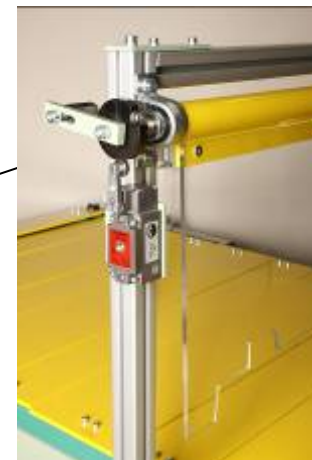
Откидная крышка с выключателем аварийной остановки.
