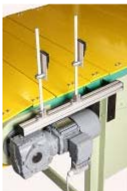
Приводной и поворотный узлы с мотор-редуктором; Валы и звездочки надежно защищены полной облицовкой из листовой стали.
