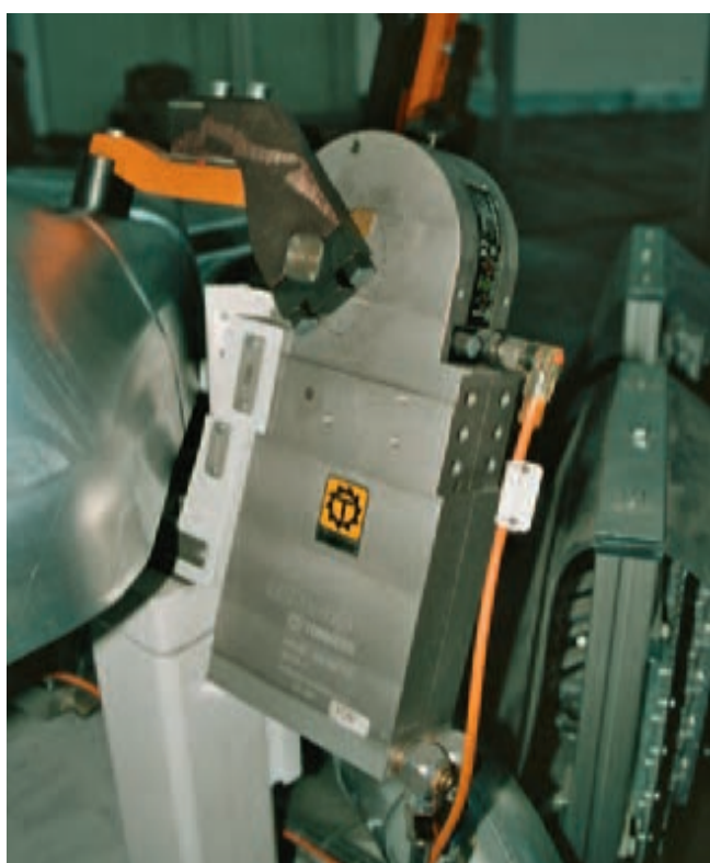
Подробно: Зажим Alpha с контуром детали
