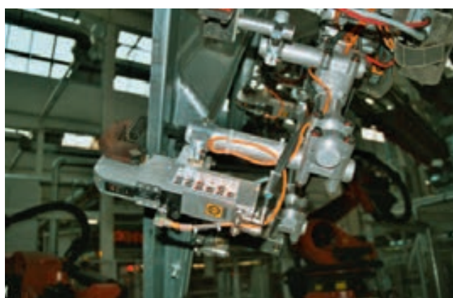
Зажим Alpha в роботизированном захвате
